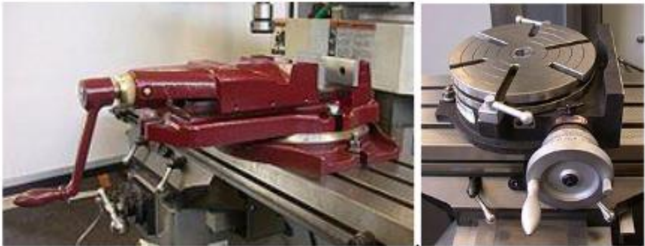
Mordaza para sujetar piezas y Mesa de trabajo giratoria.
